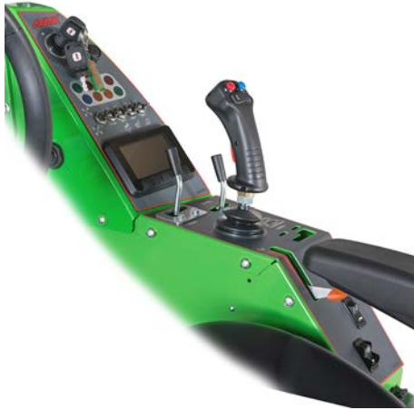
Alle schakelaars zitten bij de handgashendel
